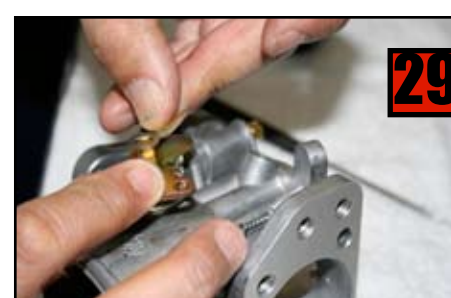
Install lock tab.
